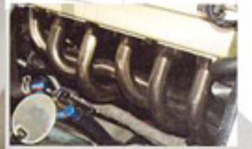
等長のステンレスパイプで構成されるEXマニホールドも快調。パワーアップはもちろん気持ちのいいサウンドを実現している。
