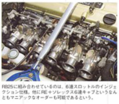
RB25に組み合わせているのは、6速スロットルのインジェクション仕様。他にRE+ソレックス6速キャブというなんとマニアックなオーダーも可能であるという。
